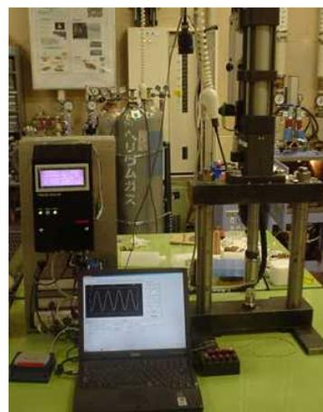
図1 あつかんサーボを、用いて試作した疲労試験機の外観
