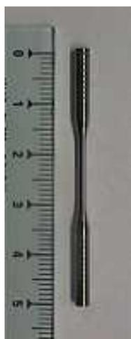
図2  $Zr_{50}Cu_{40}Al_{10}$  ガラス合金疲労試験片の外観
