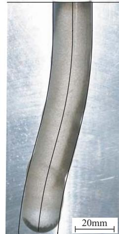
図6. 加工した曲線管路の断面写真および目標形状との比較
