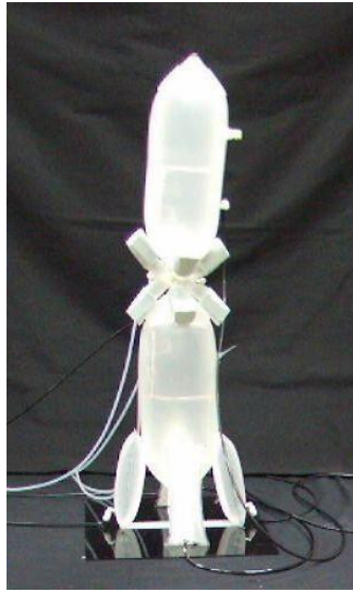
図6 2自由度関節の2リンクアーム
