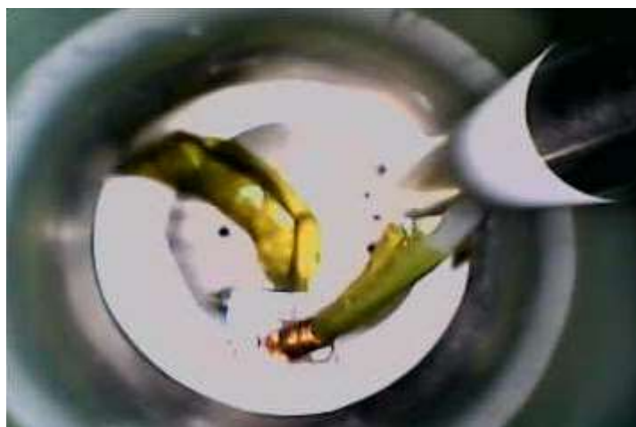
図3 試作したアクチュエータの液体窒素温度環境における駆動の様子
