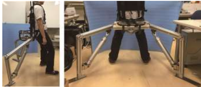
図 2 製作した荷重支持アームの実験機
