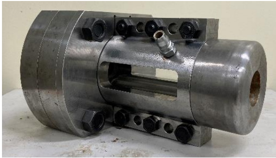
図 5 衝撃圧伝ば速度測定用水圧室 （観察窓付き）
