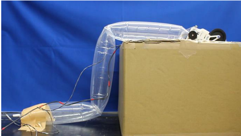
図4 マニピュレータによる段差乗り越え
