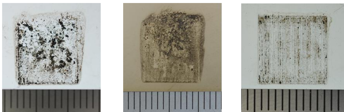
(a) 表面に凹凸がある例 (b) 成形に失敗している例 (c) 形状成形に成功した例
