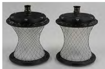
図1 試作した鼓型空気圧人工筋肉
