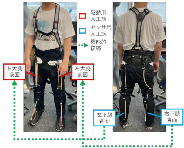
図 3 機能的接続を備えた人工筋アシストスーツ
